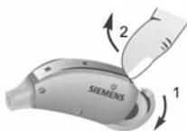
Откройте батарейный отсек и приподнимите крышечку при помощи кончика пальца как показано на иллюстрации.
