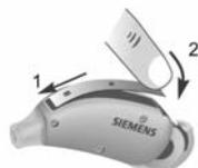
Возмите новую крышечку для микрофона таким образом, чтобы два зубчика находились у верхнего края и прикрепите к корпусу аппарата. Крышечку для микрофона рекомендуется менять каждые 3 месяца или чаще, по мере необходимости.
